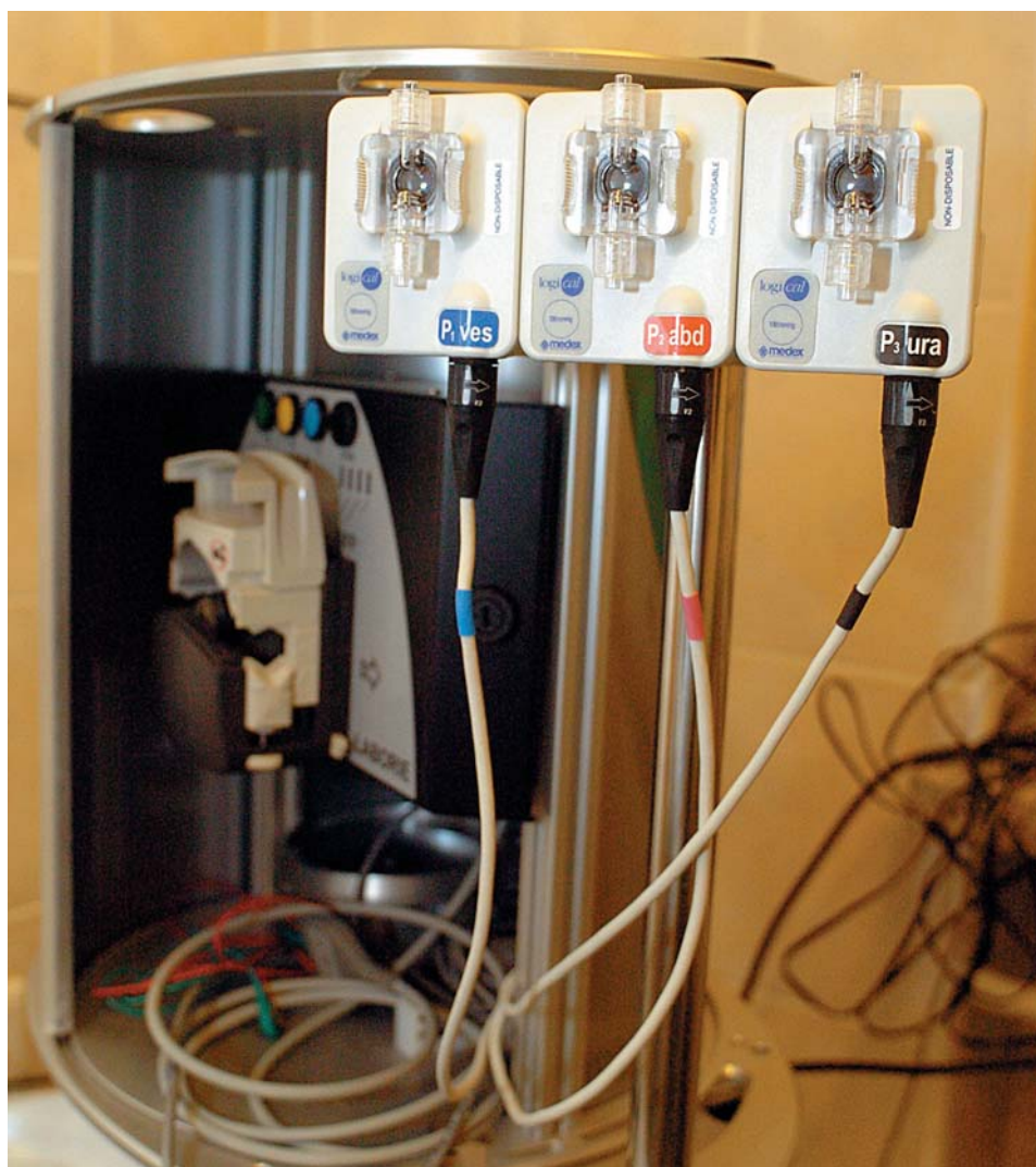
Czujniki ciśnieniowe w urządzeniu do badań urodynamicznych
