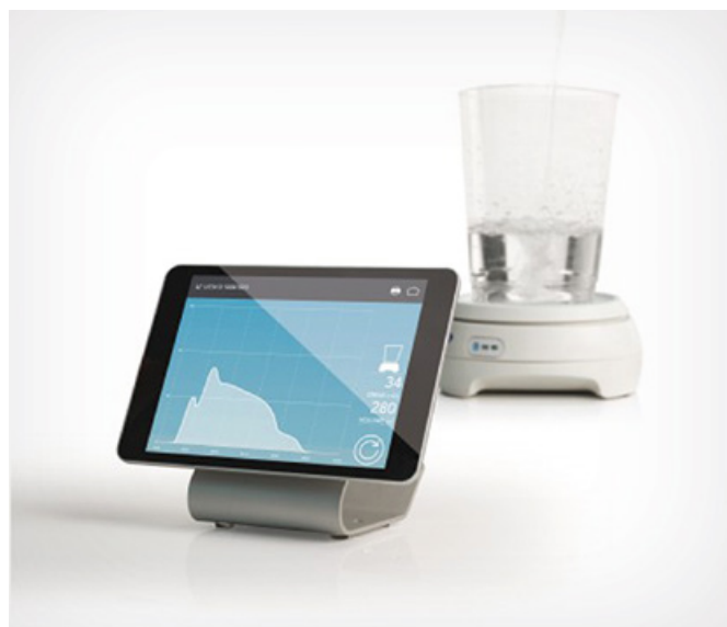
Przykład uroflowmetru - po lewej widoczne jest urządzenie pomiarowe, po prawej - pojemnik pomiarowy, do którego oddaje się mocz (źródło: Meden Inmed)
