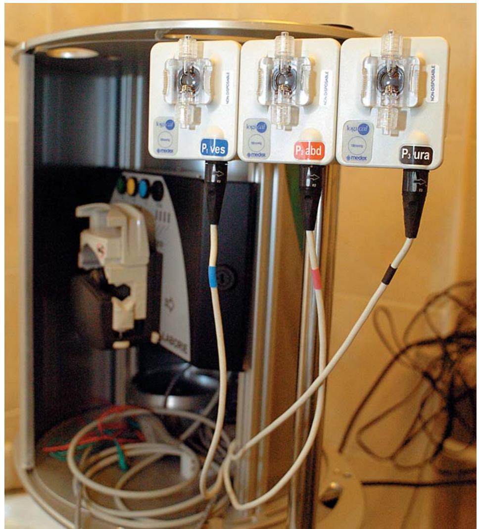
Czujniki ciśnieniowe w urządzeniu do badań urodynamicznych
